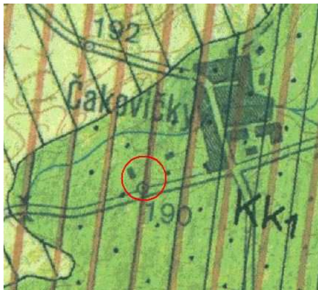
Výřez z hydrogeologické mapy ... puklinovo-průlinový kolektor korycanských vrstev T: 4,2 \cdot 10^{-5} - 2,3 \cdot 10^{-4} \text{ m}^2 \cdot \text{s}^{-1} , s_y = 0,37
