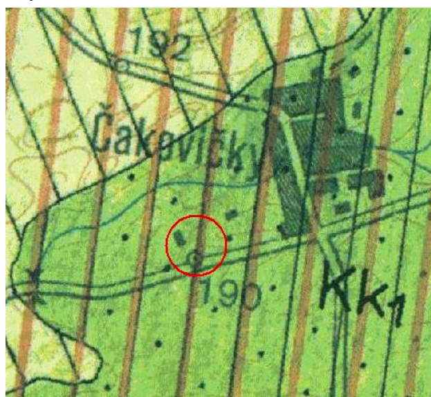
Výřez z hydrogeologické mapy o puklinovo- pr. linový kolektor korycanských vrstev T: 4,2 \cdot 10^{-5} \text{ až } 2,3 \cdot 10^{-4} \text{ m}^2 \cdot \text{s}^{-1} , S_Y = 0,37
